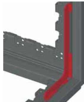
Усиленный профиль Heavy-Duty с элементом жесткости
