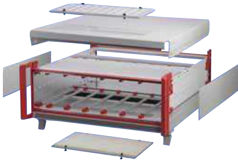
Приложение: корпус ratiopacPRO-air, окрашенный в специальный цвет, экранированная корзина для плат, фильтрующие прокладки сверху и снизу
