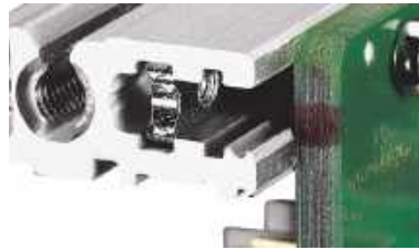
Прямой монтаж объединительной платы
