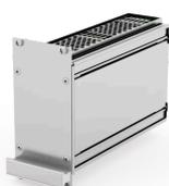
Набор для монтажа вставных блоков рамного типа PRO, с экранированием, вариант с перфорированными крышками с винтовым креплением, несколько разъемов, высота 3 U, ширина стойки 21 HP, 227 мм
