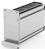
Набор для монтажа вставных блоков рамного типа PRO, с экранированием, вариант с перфорированными крышками с винтовым креплением, 1 разъем, высота 3 U, ширина стойки 21 HP, 227 мм
