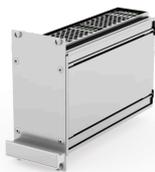
Набор для монтажа вставных блоков рамного типа PRO, без экранирования, вариант с перфорированными крышками с винтовым креплением, 1 разъем, высота 3 U, ширина стойки 21 HP, 167 мм
